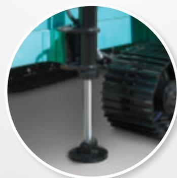
Equipada com patolas hidráulicas, a Hélice Contínua EVOMAQ® mantém o equipamento nivelado e a estaca no prumo, possibilitando maior qualidade e segurança na execução das perfurações.
