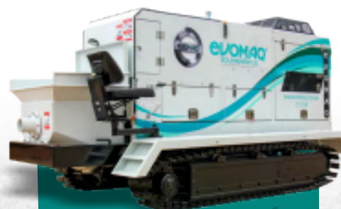
BOMBA DE CONCRETO SOBRE ESTEIRA EVOMAQ®
