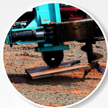
Para dar mayor estabilidad y seguridad en el momento de la ejecución del pilote, el soporte de la torre posee grandes dimensiones, lo que garantiza mayor estabilidad de la máquina y precisión en el momento de sacar la hélice.
