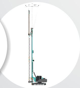
ELEVACIÓN DE LA TORRE
